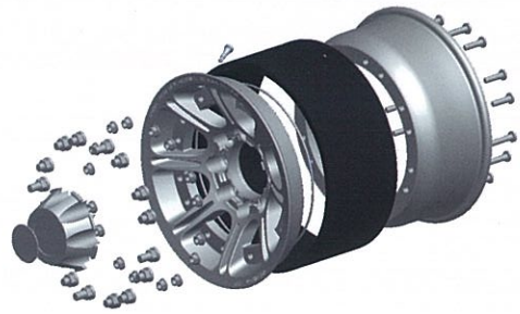
Explosionszeichnung Radaufbau HUTCHINSON Beadlock Felgen
